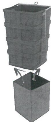
Forra chapa ou polietileno montada no interior do contentor 5m 3 papel
